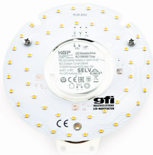
Produktfoto einer auf R130 umgerüsteten Deckenleuchte
