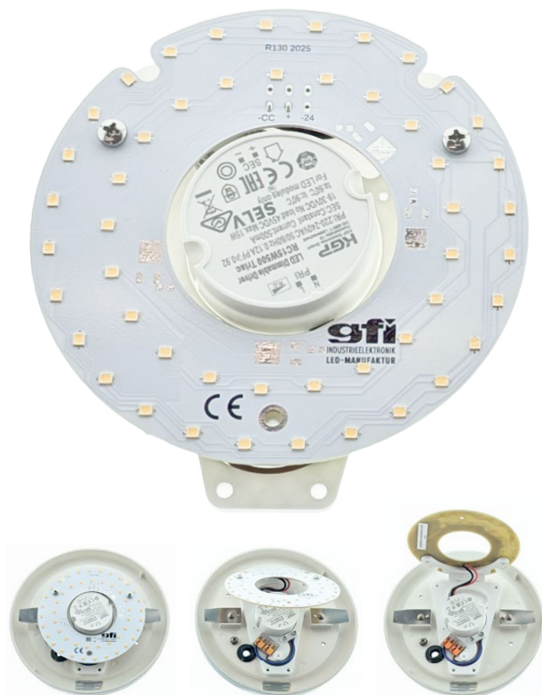
Produktfotos einer auf R130 umgerüsteten Deckenleuchte
